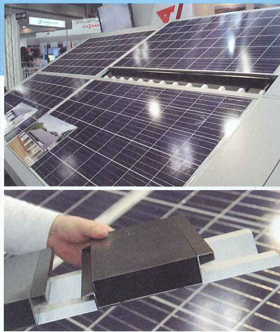
右上は、屋根材一体型太陽光発電パネル「カナメソーラールーフⅡ（仮称）」を正面から見たところ。多結晶型の太陽電池を用いることで同社の従来製品よりコストを下げた。右下は、縦方向の接合部の納まり。さねを利用した簡便な納まりとなっている。左は、側面から見たところ。ガルバリウム鋼板の折板をアルミフレームのモジュールに裏打ちすることで、現場ではモジュールを固定して結線するだけで済む
