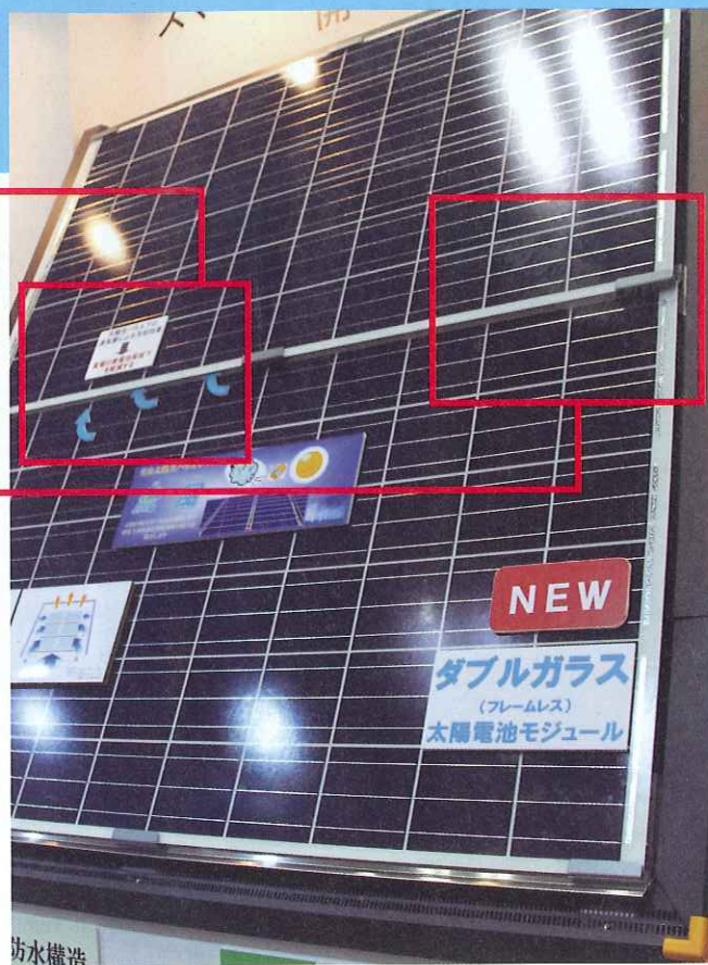
右は、スマートパワーとエバーが開発中の通気によってモジュールの温度上昇を抑える屋根材一体型太陽光発電パネル「流風」を正面から見たところ。左上は、「流風」のモジュール間のディテール。瓦屋根のように段差を付けて置くことで裏面に通気が得られ、モジュールが冷却される。左下は、「流風」の側面端部のディテール。一般的な太陽光発電パネルのようにアルミなどのフレームがなく薄いので、側面に数mmの隙間と段差をつくり通気が得られる (写真：本誌)
