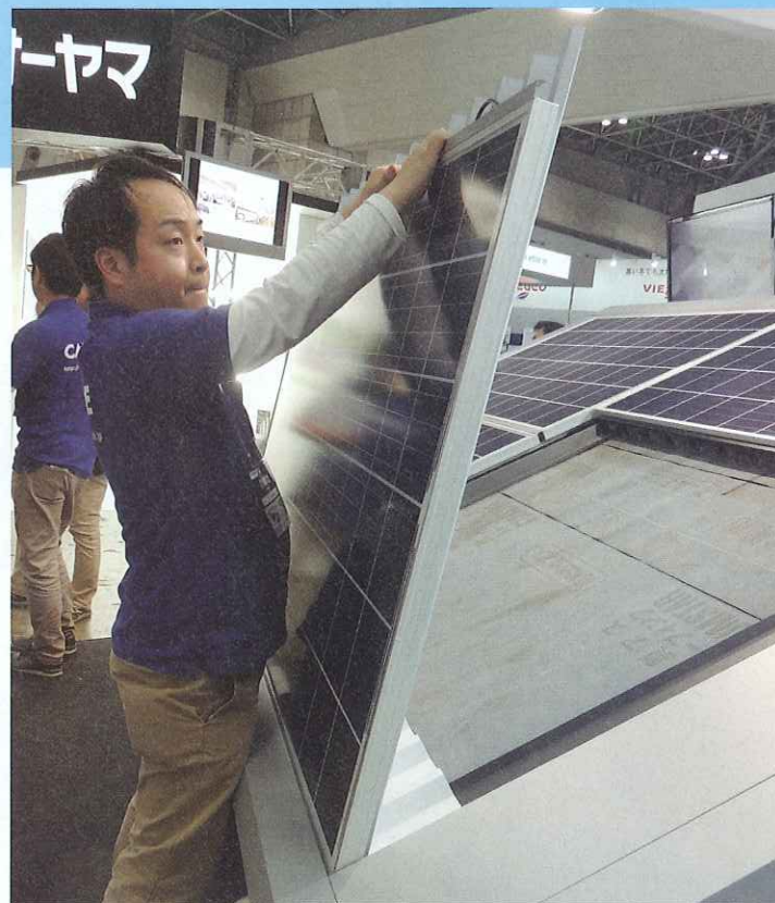
右上は、屋根材一体型太陽光発電パネル「カナメソーラールーフⅡ（仮称）」を正面から見たところ。多結晶型の太陽電池を用いることで同社の従来製品よりコストを下げた。右下は、縦方向の接合部の納まり。さねを利用した簡便な納まりとなっている。左は、側面から見たところ。ガルバリウム鋼板の折板をアルミフレームのモジュールに裏打ちすることで、現場ではモジュールを固定して結線するだけで済む
